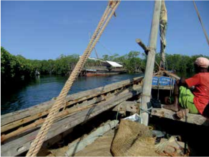
Dhow på vej ind i mangroveskoven. Udriggerbjælken ligger på langs i bagbord side.
